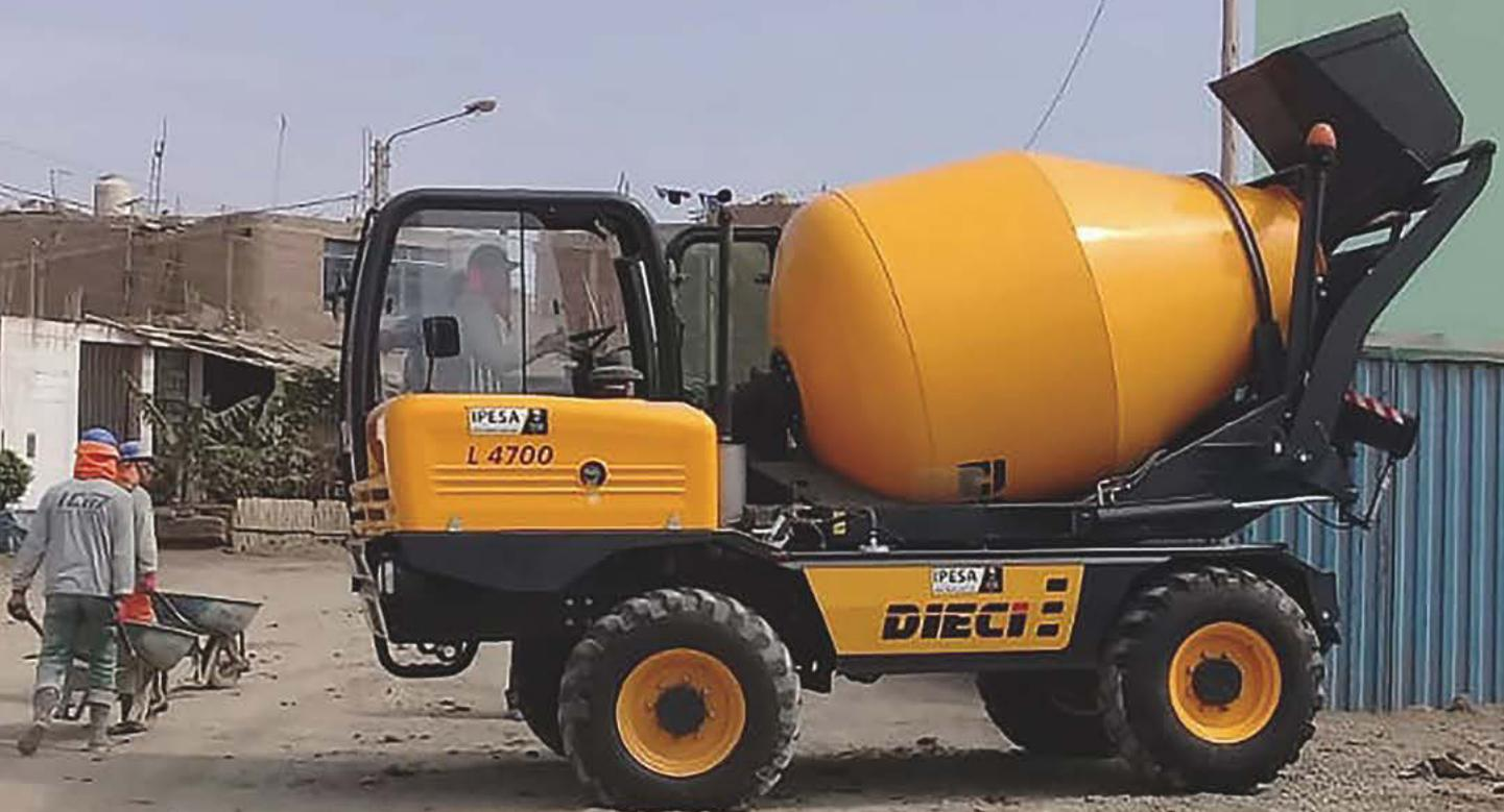
***“... Nei cantieri sono impiegate numerose autobetoniere DIECI L4700, mezzi che si sono rivelati particolarmente utili e versatili, dovendo operare spesso in luoghi impervi, lontani da centri di rifornimento, e con una scarsa presenza di acqua, ingrediente necessario per produrre le grandi quantità di cemento richieste nei cantieri....”***
