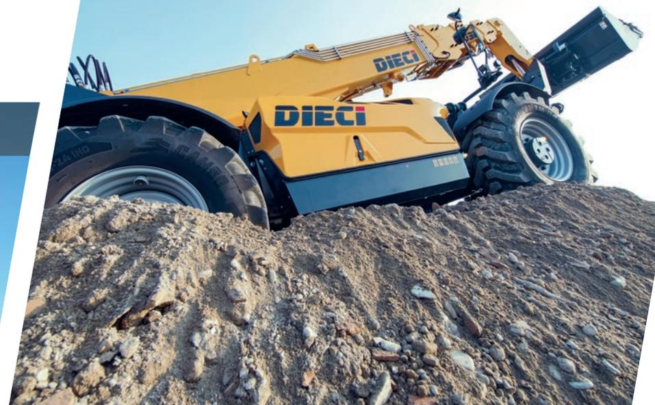
Icarus Dynamic erhebt sich in der Neuen Produktlinie für den Bausektor in luftige Höhen: die Hubhöhe beträgt **bis zu 18 Metern** unter Gewährleistung **maximaler Stabilität** durch unabhängige Abstützungen mit Proportionalsteuerung.
