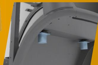
Hintere hydraulische Dämpfer
